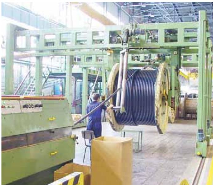
Технология создания кабельной изоляции из сшитого полиэтилена появилась в 70-х годах XX века. Сшивка — создание пространственной решетки за счет образования продольно-поперечных связей между макромолекулами полимера. По сочетанию физических и электрических свойств, сшитый полиэтилен идеально подходит для изоляции кабелей среднего, высокого и сверхвысокого напряжения.
